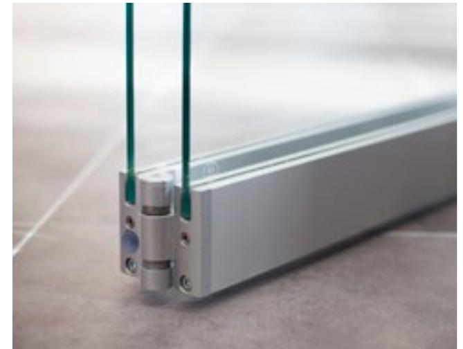
Ausführung Faltanlage Reihe 100 mit oberer und unterer Türschiene – ohne untere Führungsschiene Oberfläche E6/EV1 eloxiert Glas ESG 10 mm
