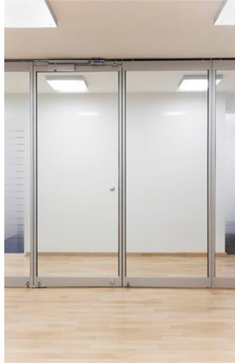
Ausführung HSW Anlage Reihe 700 gerahmt mit 2 Dreh-Endflügeln Oberfläche E6/EV1 eloxiert Glas VSG aus 2 x TVG 5 mm
